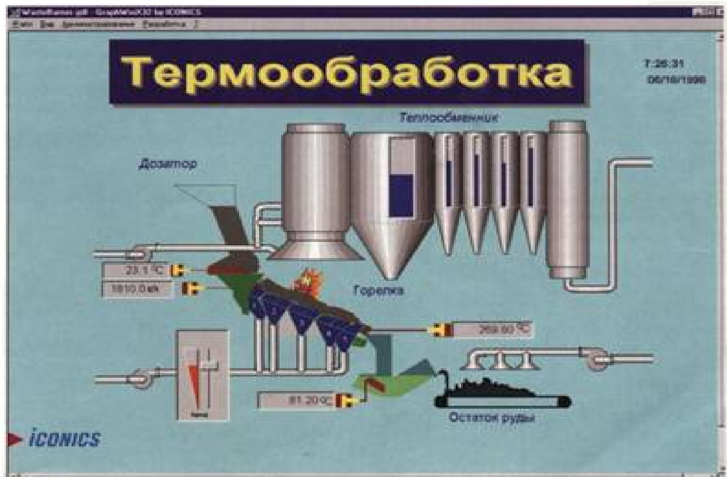
Рис. 1. Пример мнемосхемы объекта управления, созданной с помощью GraphWorX32
